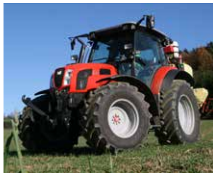
Mit Kabinenfederung und gefederter Vorderachse fährt sich der Same Virtus 100 Infinity sehr komfortabel.
