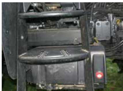
Vom Reifen aufgeworfener Schmutz kann in die Werkzeugbox eindringen.
