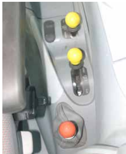
Links vom Fahrersitz sind die Hebel der Zapfwellenbedienung (gelb) angeordnet.
